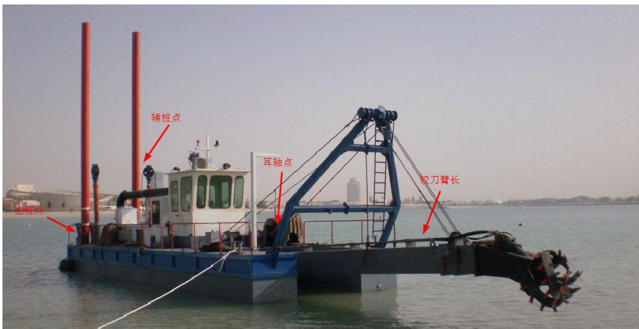
图 6-1 绞吸式挖泥船
